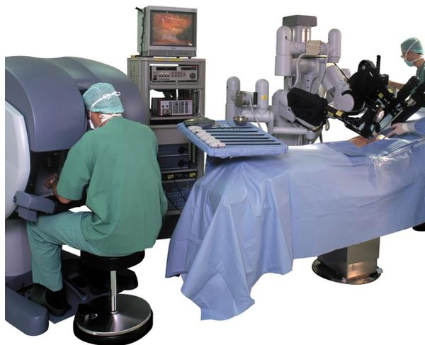
La otra parte del sistema DaVinci es la consola donde el cirujano controla todos los movimientos de cada una de las pinzas y con ayuda de imagen tridimensional puede ampliar el campo de visión al interior del cuerpo.
