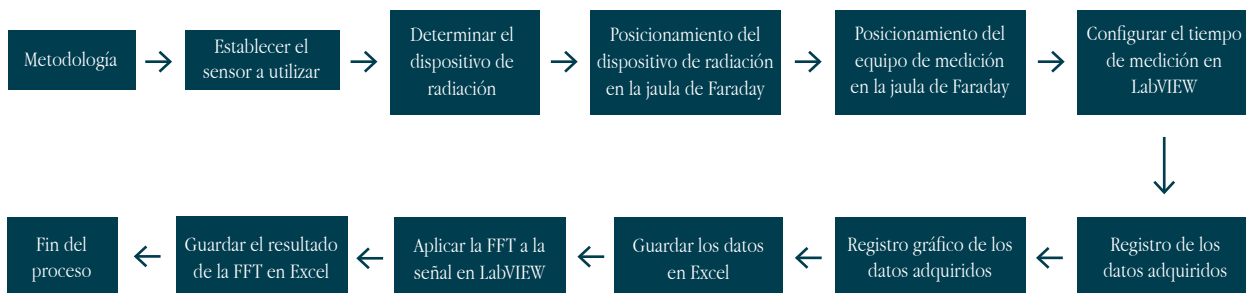
Ilustración 1. Diagrama de bloques Metodología Ambiente controlado
