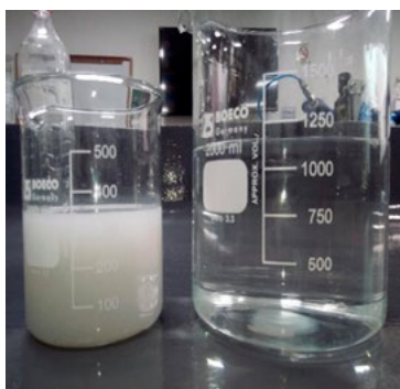
Figura 8. Muestra de agua de mar antes y después de la sedimentación acelerada en el horno
