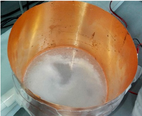
Figura 5. Separación de la sal del agua durante el proceso
