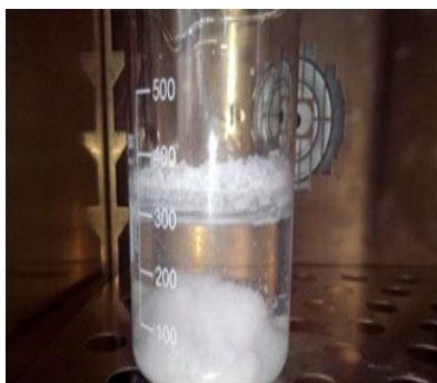
Figura 6. Sedimentación de la sal acelerada por el incremento en la temperatura
