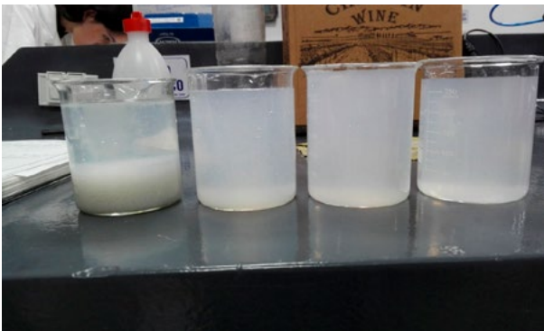
Figura 6. Estratificación de la sal después del tratamiento
