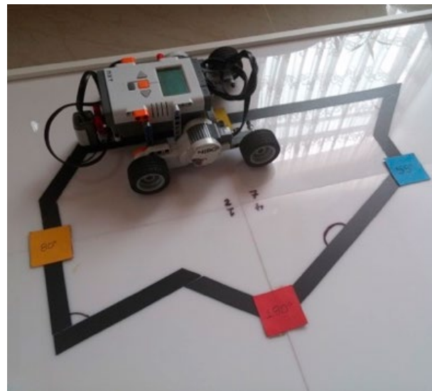
Figura 4. Robot TIKO1 y pista para las actividades de ángulos. Elaboración de los autores
