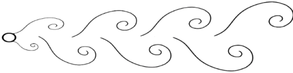
Figura 11. Representación de calles de vórtices de Kármán. El flujo (de izquierda a derecha), ante un obstáculo (círculo a la izquierda), genera turbulencias que responden a un patrón dinámico ordenado: los vórtices se alinean de forma ordenada en dos calles.
